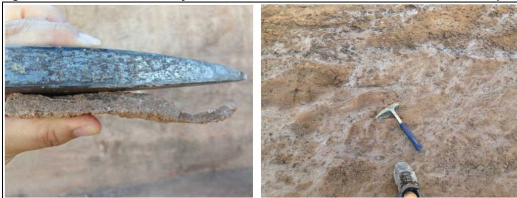
Figura 11-34: Contenido de sal y cementación de Halita en unidad Gravas de Alto Hospicio
